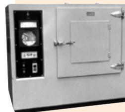
光弾性応力解析法の一つである「三次元応力解析法」(当社で開発)に用いる「応力凍結装置」
