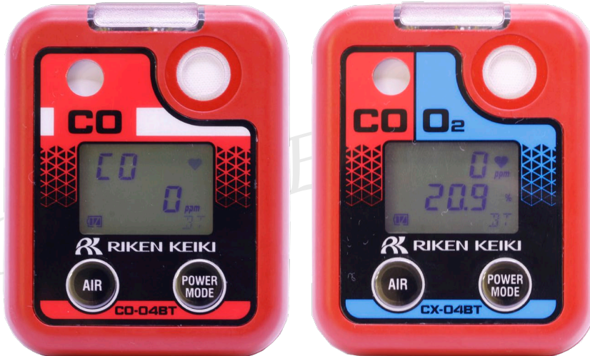
Model:CO-04BT(C-) 一酸化炭素計(水素干渉低減)
